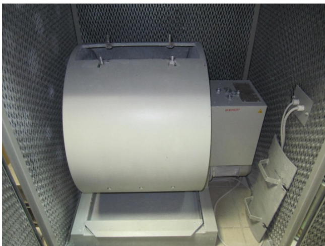
B7 pav. Los Andželo rodikliui nustatyti naudotas Los Andželo aparatas Fig. B7. Los Angeles apparatus used for determining the indicator of Los Angeles
