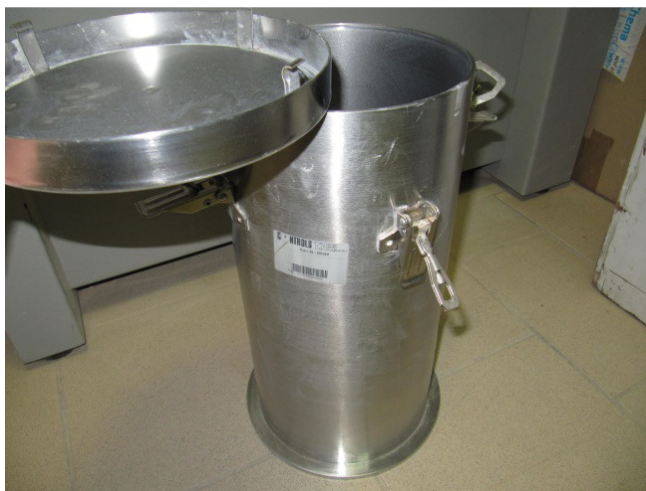
B5 pav. MDE rodikliui nustatyti naudotas būgnas Fig. B5. Drum used for determining the indicator MDE
