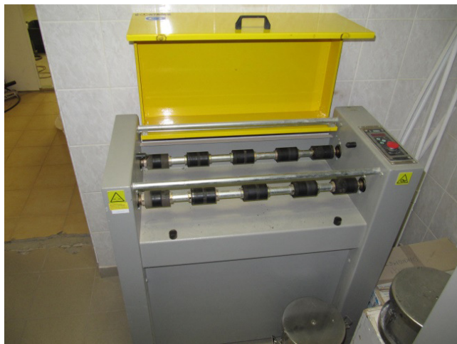
B4 pav. M_{DE} rodikliui nustatyti naudotas mikro-Devalio aparatas Fig. B4. Micro-Deval apparatus used for determining the indicator M_{DE}
