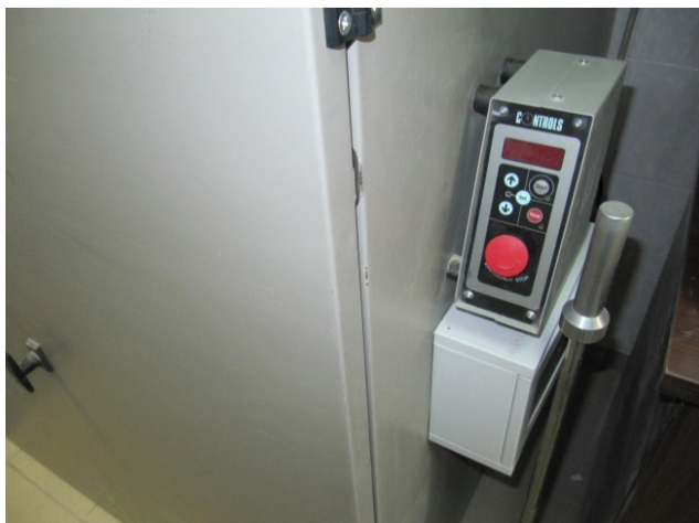
B8 pav. Los Andželo rodikliui nustatyti naudoto aparato valdiklis–apsisukimų skaitiklis Fig. B8. Controller – revolution counter used for determining the indicator of Los Angeles
