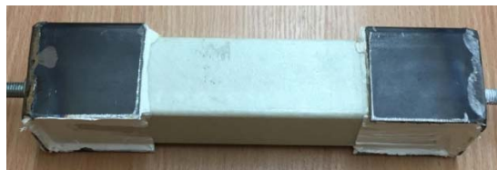
B4 pav. Klijuotinės jungties bandinys (plienas + stiklo pluoštas)
