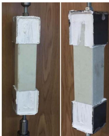
B5 pav. Klijuotinių jungčių tempimo bandymai
