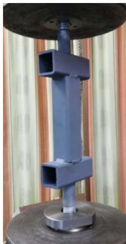
B2 pav. Virintinės jungties tempimo bandymas Fig. B2 Tensile test of welded joint
