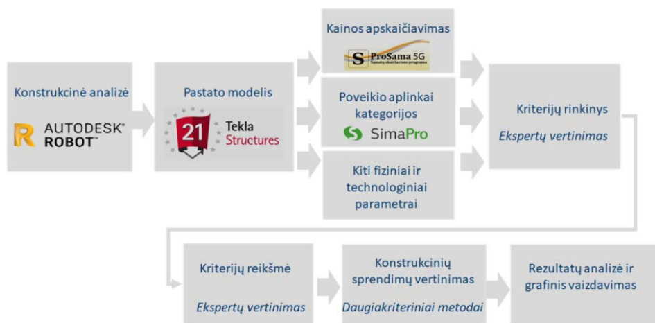
3.5 pav. Informacijos srautas analizuojant tiriamąjį objektą Fig 3.5. Information flow when analyzing the research object
