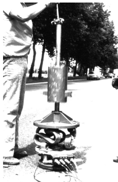
B.1 pav. Dinaminis dangos stiprio nustatymo prietaisas FWD, pagamintas kompanijos TU–Delft (1978 m.) (Pavement... 2010).
