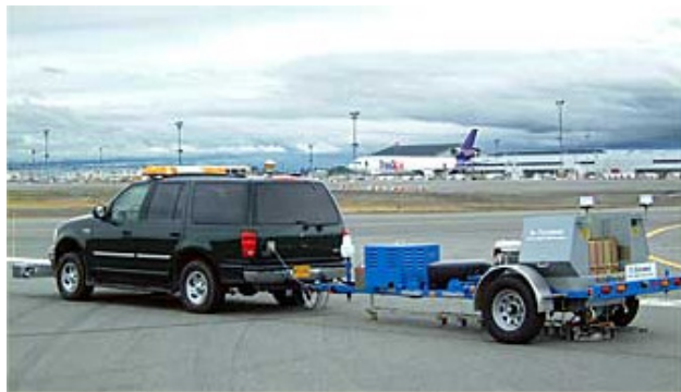
B.9 pav. Sunkaus svorio deflektometras (HWD)
