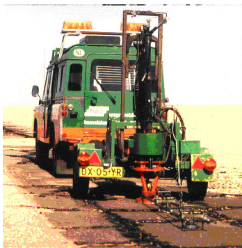
B.3 pav. Phonix kompanijos pagamintas FWD su Dynatest kompanijos elektronine sistema (Pavement... 2010).
