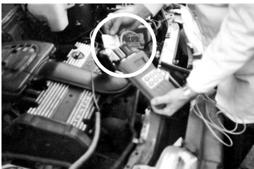
35 pav. Į testavimo įrenginį įstatoma „smart card“ kortelė (apskritime)
