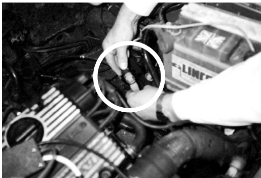
34 pav. Testavimo įrangos pajungimas (apskritime) prie automobilio Rover 200 OBD I diagnostinės jungties
