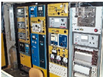
15 pav. Automobilių diagnostinės patikros stendas (apie 1980 m.)
