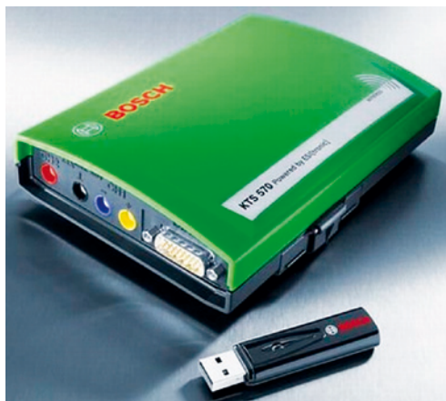
44 pav. BOSCH KTS 570 sisteminis testeris (šalia parodyta „Bluetooth“ ryšio USB jungtis)
