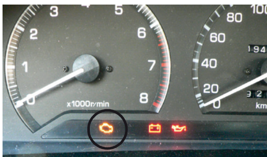
17 pav. OBD I CHECK lemputė (apskritime) automobilio Toyota Corolla Liftback 1991 m. prietaisų skyde
