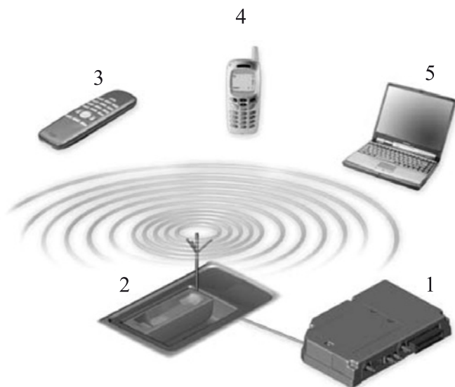
65 pav. „Bluetooth“ ryšio panaudojimas automobilyje: 1 – telefono valdymo blokas, 2 – bevielio telefono priedėlis, 3 – bevielio telefono ragelis automobilyje, 4 – mobilusis telefonas, 5 – nešiojamasis kompiuteris
