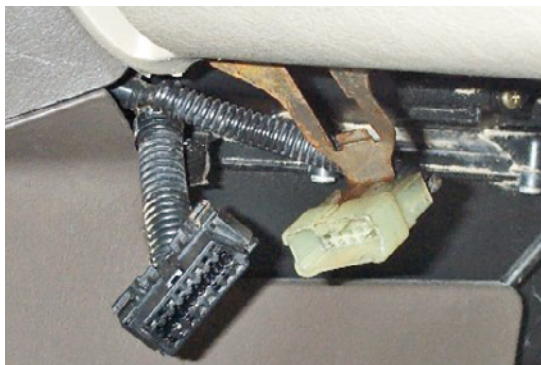
37 pav. Dviejų tipų diagnostinės jungtys automobilyje Mitsubishi (kairėje – naujojo tipo, dešinėje – senojo tipo)
