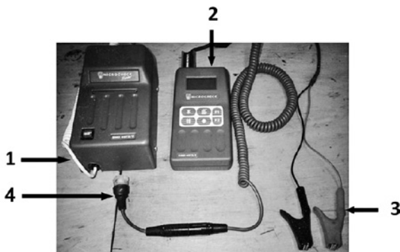
32 pav. Pirmosios OBD I diagnostinės įrangos pagrindinės sudedamosios dalys: 1 – spausdintuvas, 2 – gedimų paieškos įrenginys, 3 – maitinimo laidai, 4 – diagnostinės jungties laidas su adapteriu
