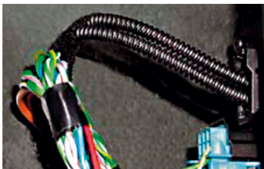
63 pav. Šviesolaidžių apsauginiai (gofruoti) vamzdeliai automobilyje
