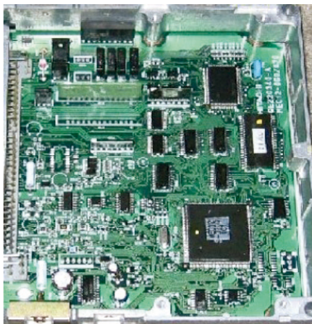
38 pav. Motorolla MPC565 valdymo blokas (vidinė struktūra)
