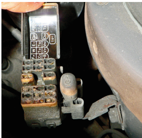
20 pav. Automobilio Toyota Corolla Liftback 1991 m. OBD I diagnostinės jungties kontaktai
