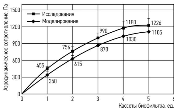
Рис. 5.25. Сравнение результатов эксперимента и полученных моделированием
