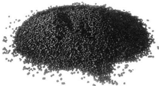
**Рис. 2.11.** Цилиндрические гранулы формованного угля фирмы *Silcarbon Aktivkohle GmbH*
