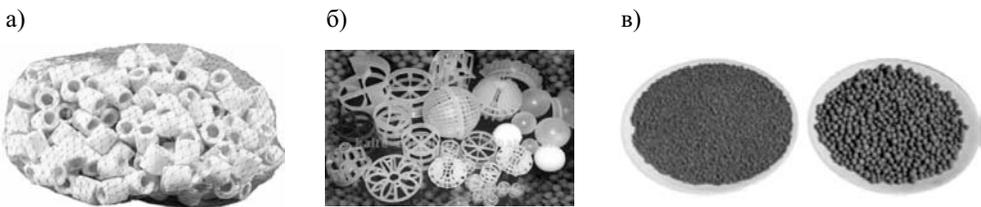
**Рис. 2.21.** Синтетические загрузки: а) стеклянная; б) пластиковая; в) из керамических гранул
