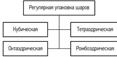
**Рис. 2.4.** Виды регулярной укладки монодисперсного слоя шаров
