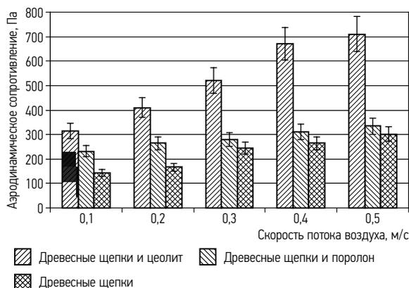
**Рис. 4.75.** Зависимость аэродинамического сопротивления биофильтра, заполненного разной загрузкой, от скорости потока подаваемого воздуха
