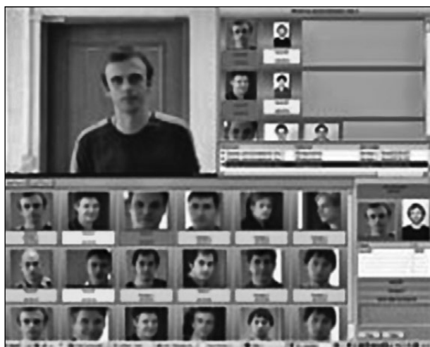
Рис. 1.2. Сканирование изображения, поступающего с телекамеры, и выделение кадра, на котором оно имеет оптимальные размеры и ракурс (Система захвата ... 2011)
