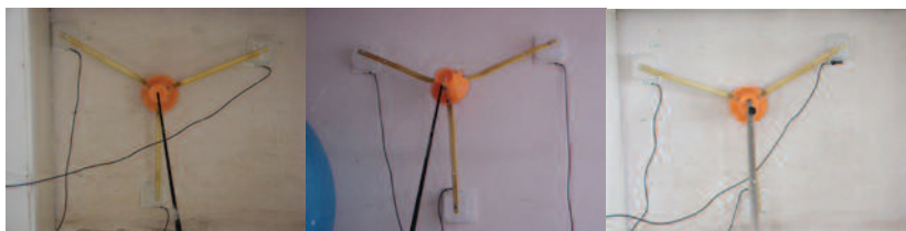
12.2 pav. Laboratorinė įranga, matuojanti šilumos srautus per išorines atitvaras
