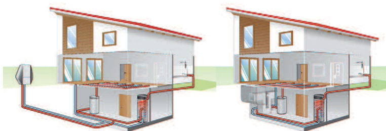
8.11 pav. Šilumos siurblių oras/vanduos sistemos: lauke ir patalpoje
