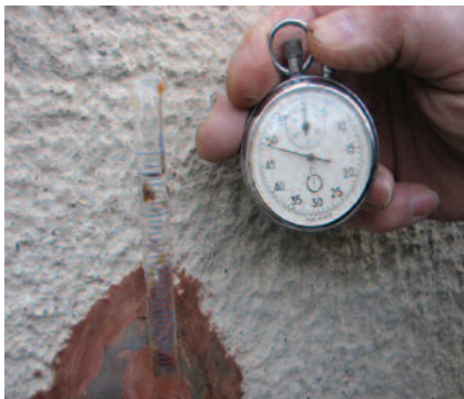
3.2 pav. Fasado įgerties bandymas „KARSTEN“ prietaisu
