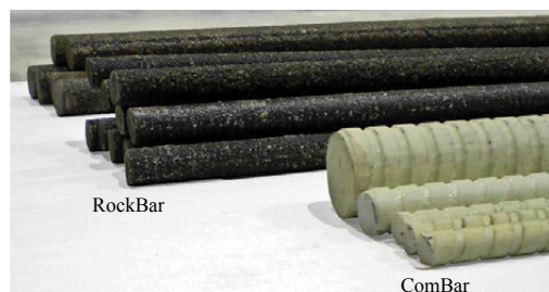
7.9 pav. Bazalto pluošto RockBar (dengti smėliu) ir stiklo pluošto ComBar (suformuoti rumbeliai) kompozitinės armatūros pavyzdžiai
