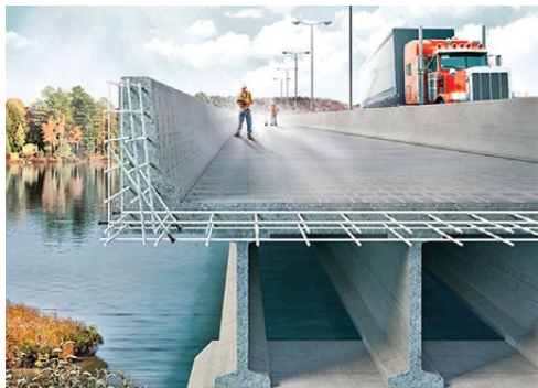
6.1 pav. Kompozitinės armatūros naudojimas tiltų statyboje („Schöck Bauteile GmbH“)
