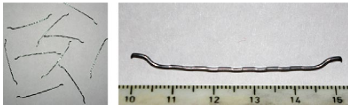
5.6 pav. Dispersiniam sijos armavimui naudojamas plaušas
