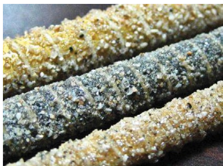
7.7 pav. Kompozitinių strypų paviršiai, padengti smėlio sluoksniu
