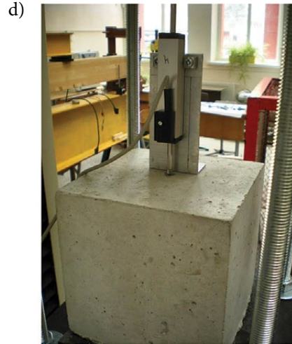
10.5 pav. Ištraukimo bandymas: a – armatūros strypų ruošiniai; b – aliumininiai kampučiai, pritvirtinti šalia laisvojo armatūros galo; c – ištraukimo bandymas tempimo mašinoje; d – laisvojo galo poslinkio matavimas skaitmeniniu poslinkių jutikliu (angl. LVDT )
