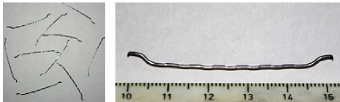
5.6 pav. Dispersiniam sijos armavimui naudojamas plaušas
