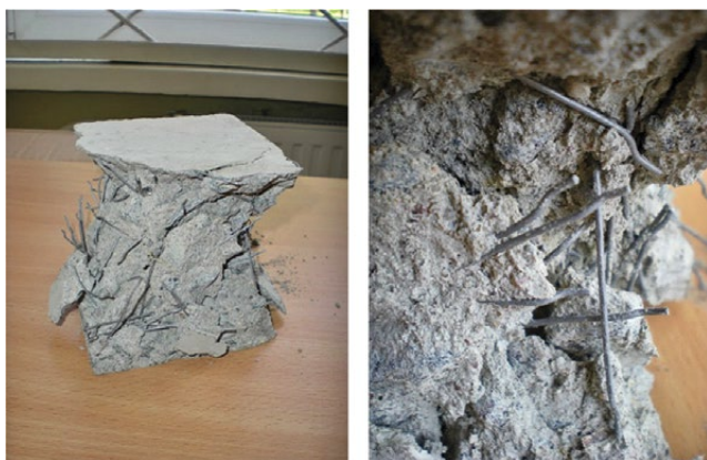
4.6 pav. Netaisyklingas fibrų išsidėstymas betone
