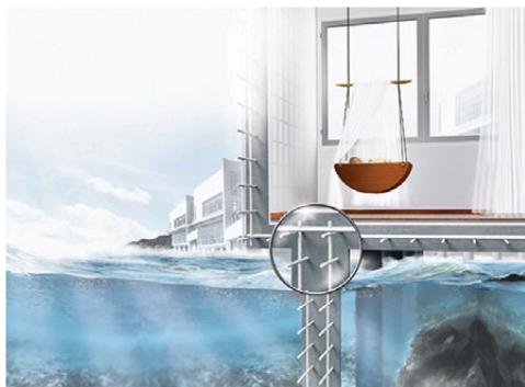
6.5 pav. Kompozitinės armatūros naudojimas pakrantės statiniams („Schöck Bauteile GmbH“)
