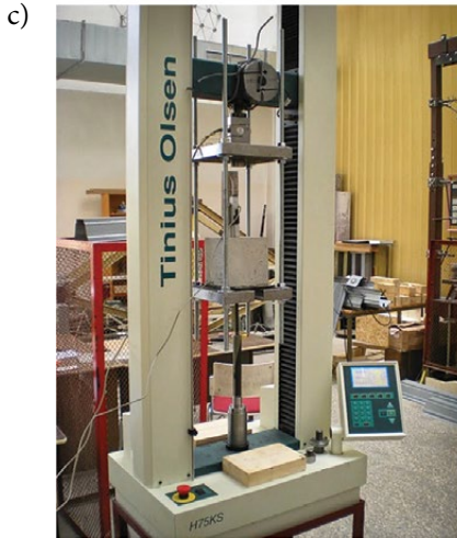
10.5 pav. Ištraukimo bandymas: a – armatūros strypų ruošiniai; b – aliumininiai kampučiai, pritvirtinti šalia laisvojo armatūros galo; c – ištraukimo bandymas tempimo mašinoje; d – laisvojo galo poslinkio matavimas skaitmeniniu poslinkių jutikliu (angl. LVDT )
