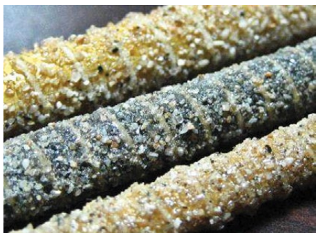
7.7 pav. Kompozitinių strypų paviršiai, padengti smėlio sluoksniu
