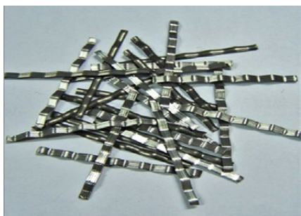
2.5 pav. Banguotas plieno plaušas iš plieninės skardos
