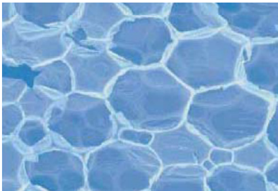
5.30 pav. Putų poliuretano akučių struktūra
