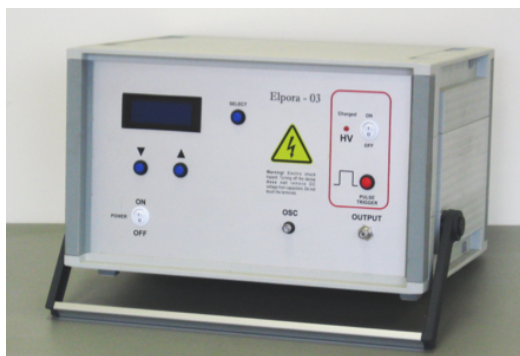
S7 pav. Sukurto iki 8 kV, 200 ns – 5 μs stačiakampių impulsų elektroporatoriaus prototipas
