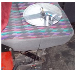
B24 pav. Vairuotojo sedynės virpesių matavimo priemonės Fig. B24. The measurement instrument of driver's seat vibrations
