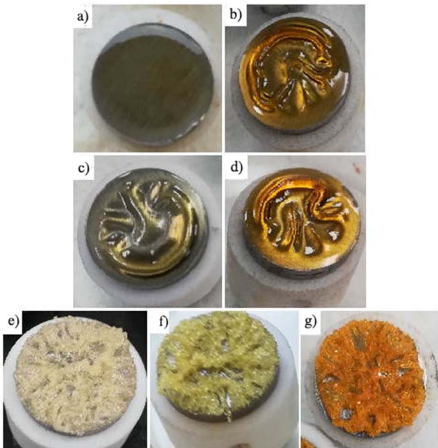
3.11 pav. Ritinėliai su aliejumi po inkubacijos 90 °C temperatūroje: kanapių aliejus – 24 val. (a); 240 val. (b); linų sėmenų aliejus – 24 val. (c); 240 val. (d); tungų medžio aliejus 2 val. (e); 24 val. (f); 240 val. (g)
